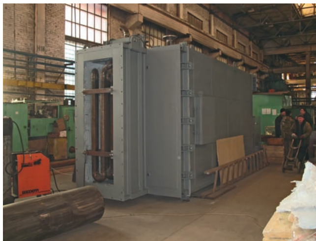
Печь для подогрева нефти змеевикового типа
