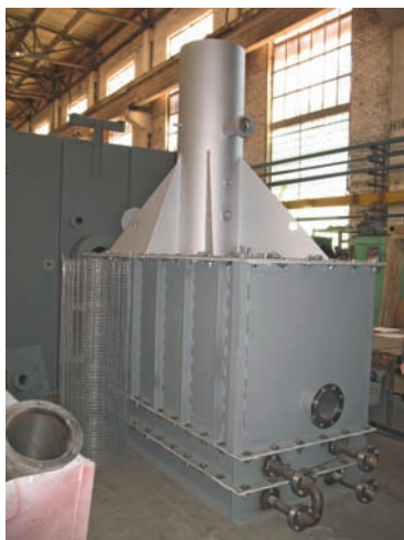
Печь для подогрева нефти змеевикового типа
